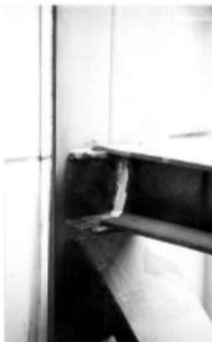
(d) Weld fracture
