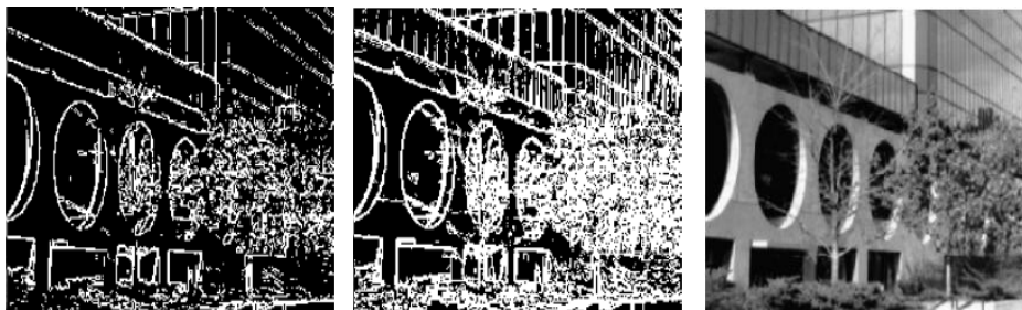
شکل 18-9: تصویر اولیه و دو تصویر لبه با استفاده از تفریق فازی با دو حد آستانه متفاوت
