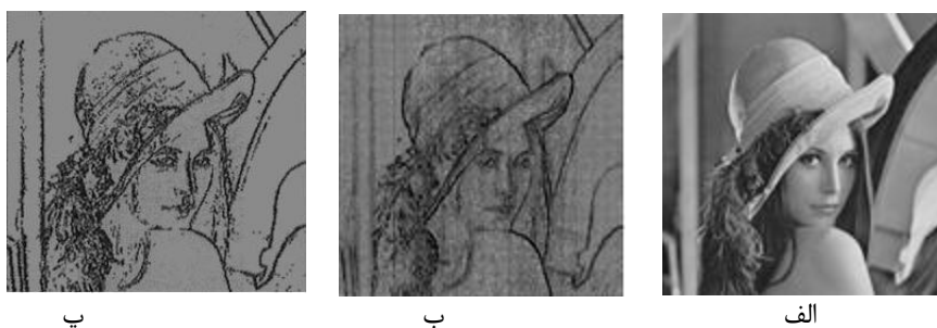
شکل 17-18: تشخیص لبه با استفاده از روش روسو و رمپونی. الف) تصویر اصلی ب) خروجی تشخیص‌دهنده لبه پ) نتیجه بعد از اعمال حد آستانه
