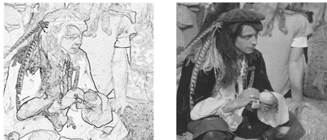
شکل 18-4: تشخیص لبه‌های تصویر با استفاده از یک روش Rule based
