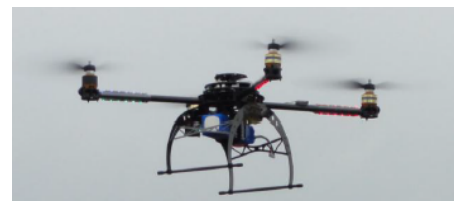
(الف) پروازگر (پهپاد) بدون سرنشین سبک وزن. (ب) دوربین مورد استفاده در پروازگر (پهپاد) بدون سرنشین. (ج) تصویر سه‌بعدی از گرمایش منطقه در یک معدن زغال‌سنگ روباز. شکل ۳-۲۲: نمونه‌ای از استفاده از سیستم‌های پروازگر (پهپاد) بدون سرنشین سبک وزن مورد استفاده در شناسایی گرمایش ناشی از خودسوزی زغال‌سنگ در معدن روباز زغال‌سنگ (Malos et al., 2013).
