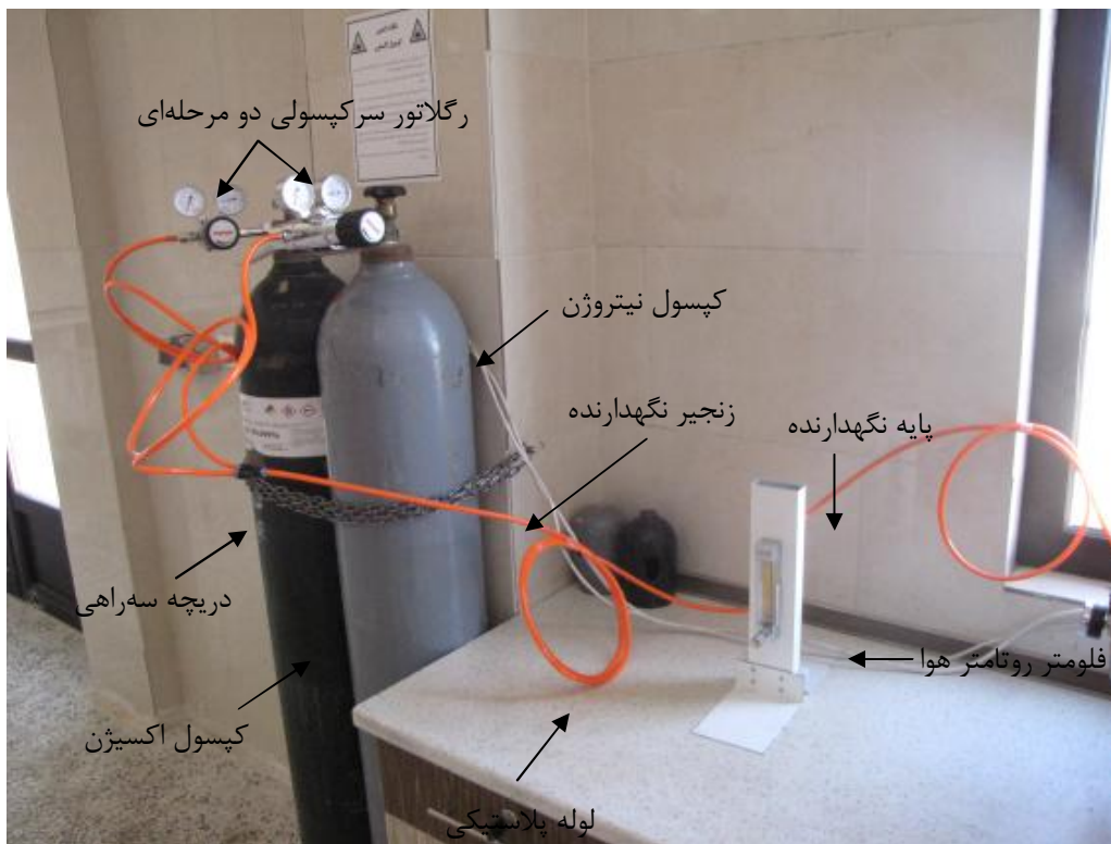
شکل ۴-۸: کپسول‌های نیتروژن و اکسیژن ۵۰ لیتری به همراه رگلاتور سر کپسولی دو مرحله‌ای و فلومتر روتامتر هوا ۳۰ تا ۳۰۰ میلی‌لیتر بر دقیقه به همراه پایه نگهدارنده آلومینیومی طراحی شده.
