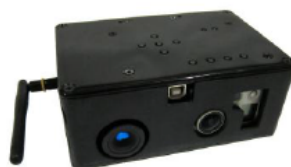
(الف) پروازگر (پهپاد) بدون سرنشین سبک وزن. (ب) دوربین مورد استفاده در پروازگر (پهپاد) بدون سرنشین. (ج) تصویر سه‌بعدی از گرمایش منطقه در یک معدن زغال‌سنگ روباز. شکل ۳-۲۲: نمونه‌ای از استفاده از سیستم‌های پروازگر (پهپاد) بدون سرنشین سبک وزن مورد استفاده در شناسایی گرمایش ناشی از خودسوزی زغال‌سنگ در معدن روباز زغال‌سنگ (Malos et al., 2013).
