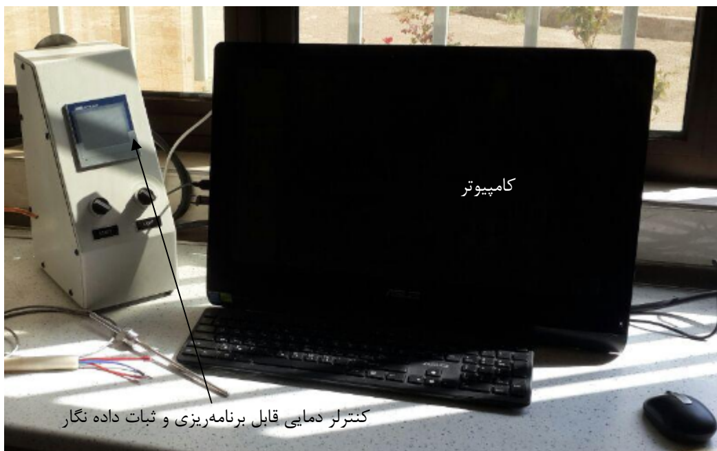
شکل ۴-۱۱: کنترلر دمایی قابل برنامه‌ریزی و ثبت داده نگار مدل JUMO Dicon touch آلمان به همراه پایه نگهدارنده و کامپیوتر.
