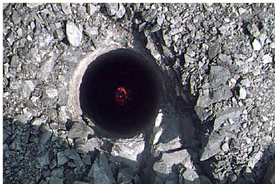
شکل ۳-۲۳: نمونه‌ای از گمانه پایش و اندازه‌گیری گرمایش خود به خودی لایه زغال‌سنگ (Gangopadhyay, 2008).
