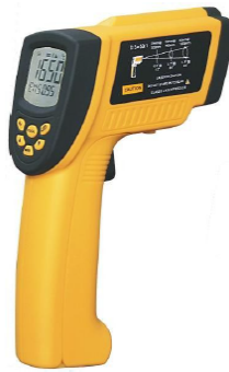
شکل ۳-۲۴: نمونه‌ای از دستگاه گرماسنج مادون قرمز بدون تماس فیزیکی (www.omega.com, 2016).
