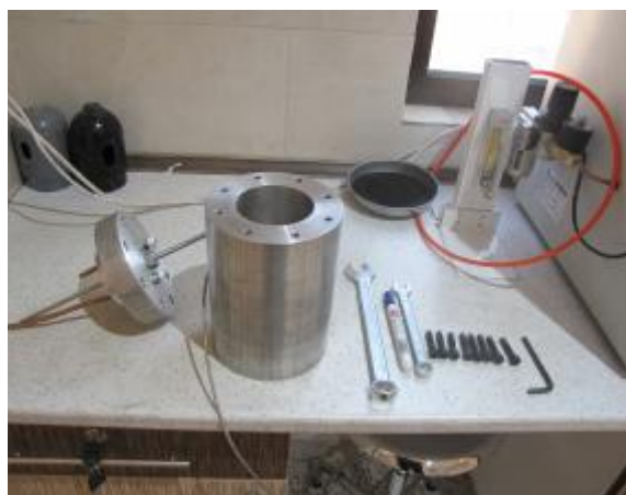
شکل ۴-۱۴: نمای کلی از رآکتور آدیباتیک واکنش به همراه لوله‌های ورود و خروج گاز و سنسور دمایی.
