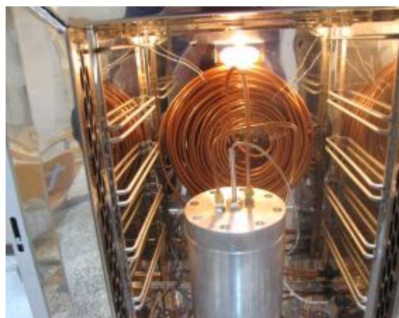
شکل ۴-۱۴: نمای کلی از رآکتور آدیباتیک واکنش به همراه لوله‌های ورود و خروج گاز و سنسور دمایی.
