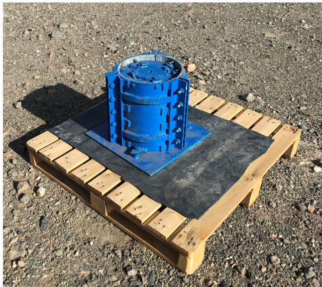
شکل ۴-۱۷- محفظه مورد استفاده در انفجار های کوچک مقیاس
