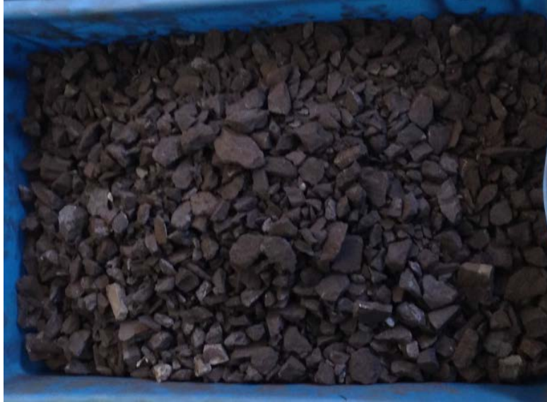
شکل ۳-۳- ترکیب مواد معدنی انفجارشده با اندازه بین ۲۵ و ۴۰ میلی‌متر برای یک ردیف انفجارشده
