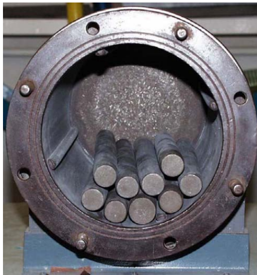
شکل ۳-۱۵- آسیا آزمایشگاهی مورد استفاده در دانشگاه مونتان یونیورسیتات
