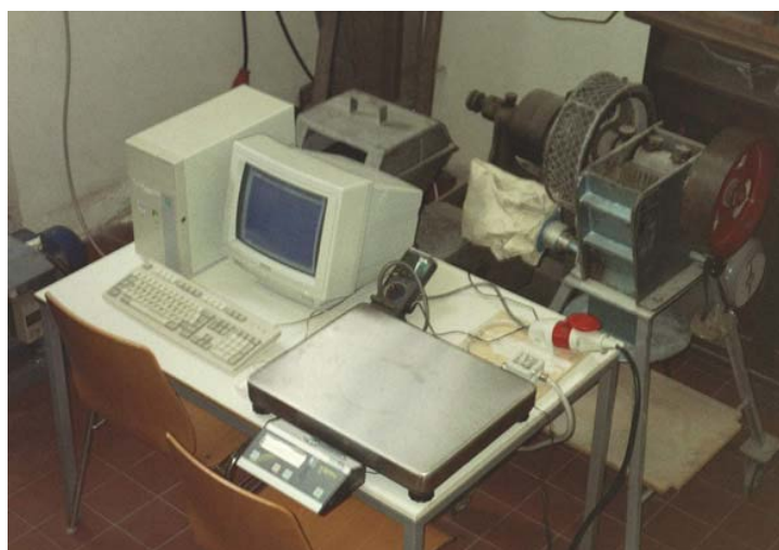
شکل ۳-۹- تجهیزات مورد استفاده در تهیه نمودار انرژی مصرفی-زمان
