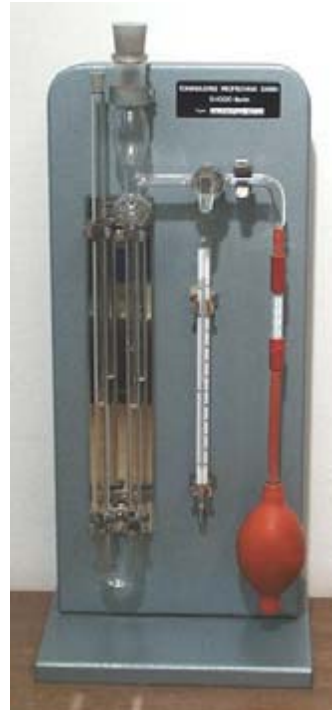
شکل ۳-۱۸- دستگاه بلین برای اندازه‌گیری سطح ویژه ذرات شکل ۳-۱۹- دستگاه پرمپان برای اندازه‌گیری سطح ویژه ذرات
