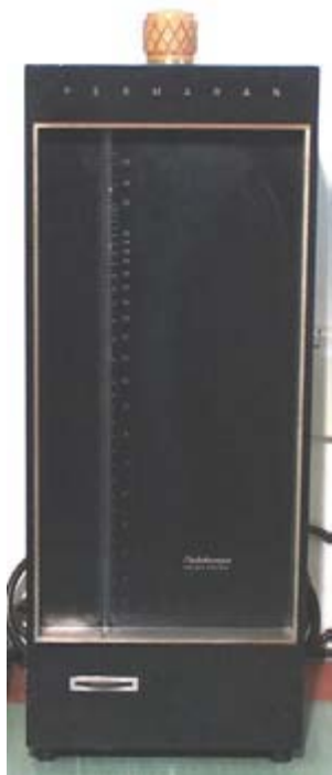
شکل ۳-۱۸- دستگاه بلین برای اندازه‌گیری سطح ویژه ذرات شکل ۳-۱۹- دستگاه پرمپان برای اندازه‌گیری سطح ویژه ذرات
