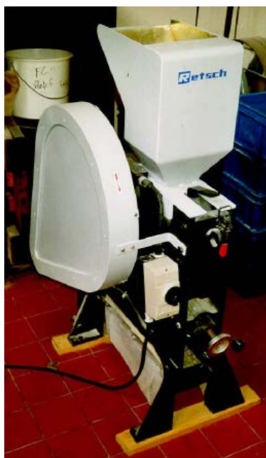
شکل ۳-۸- سنگ شکن آزمایشگاهی مورد استفاده در انجام آزمایش
