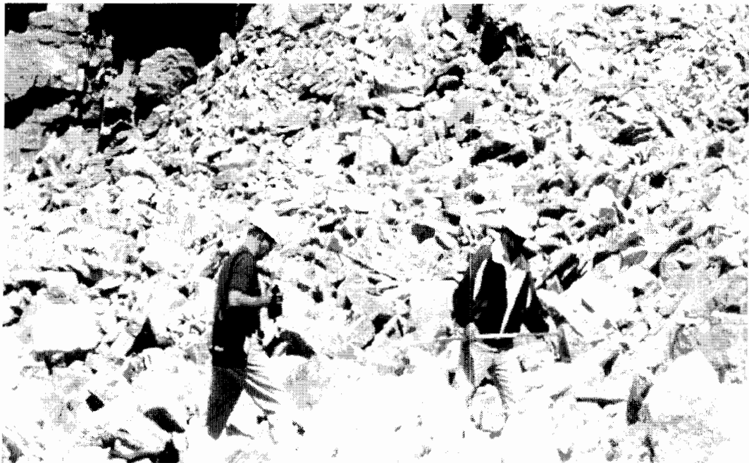
شکل ۲-۱۷ - یک نمونه از تصویر برداری از توده سنگ خرد شده پس از انفجار توسط دوربین دیجیتالی (Maerz, ۱۹۹۹)
