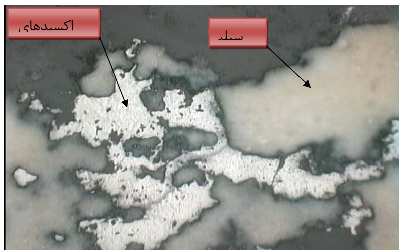
شکل ۲-۱۴: وجود سیلیس و باطله زیاد در نمونه S ۶
