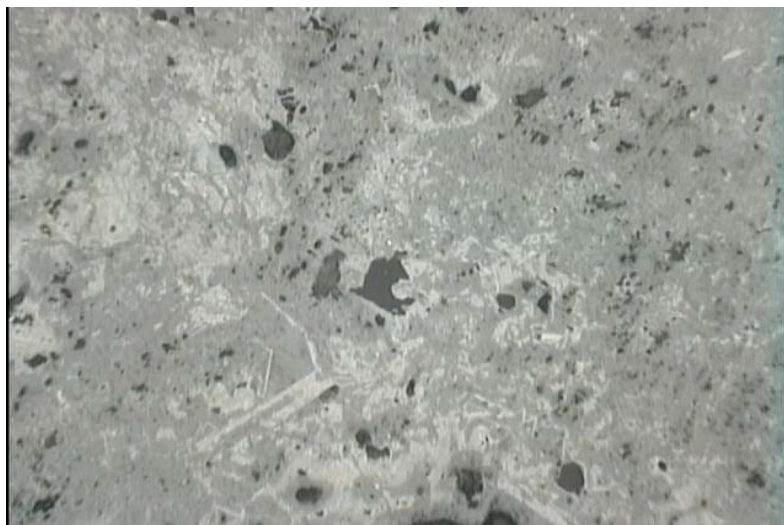
شکل ۲-۱۶: پدیده مارتیتی شدن در نمونه S ۱۱
