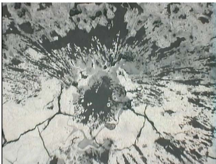
شکل ۲-۱۷: بافت شعاعی در هماتیت (نمونه S ۱۳ )
