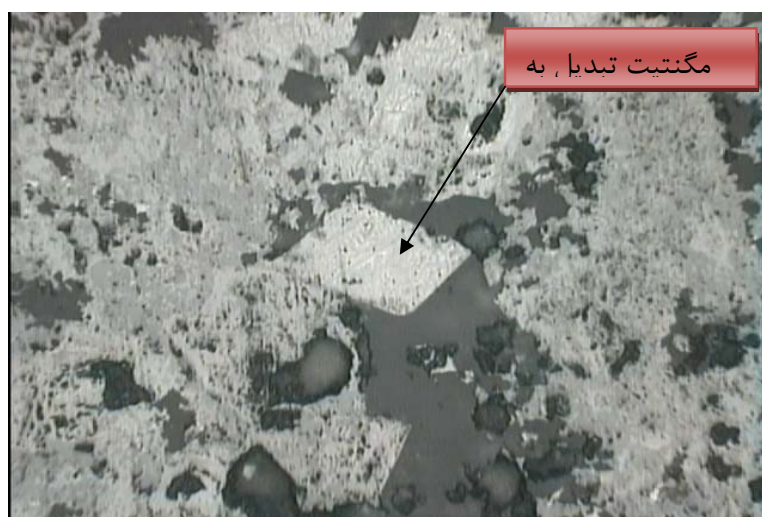
شکل ۲-۱۵: بلور مگنتیت در نمونه S ۱۲
