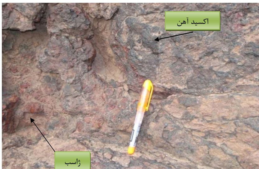
شکل ۲-۸: اکسید های آهن به همراه ناخالصی ها
