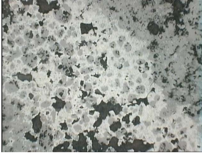
شکل ۲-۱۸: پدیده مارتیتی شدن در نمونه Si_4
