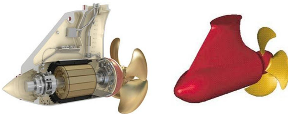
شکل ۳-۲: ساختار کلی سیستم رانش مستقیم [۵۶]
