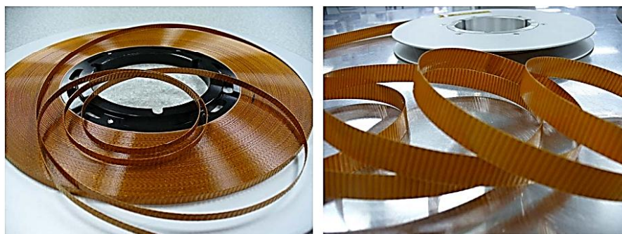
شکل ۲-۱۵: یک نوع سیم ابررسانا ساخت شرکت سوپرپاور [۲۶]
