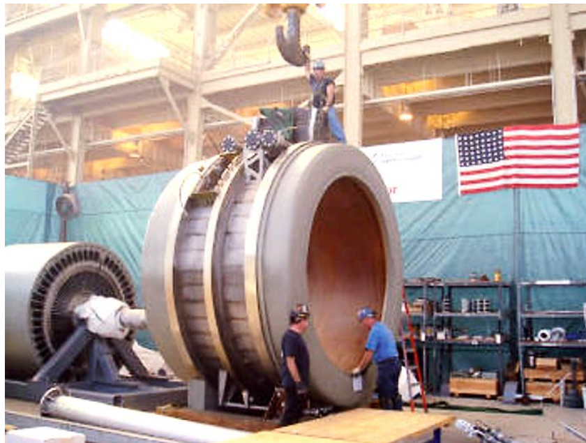
شکل ۲-۲۱: نمای کلی استاتور و روتور موتور سنکرون ابرسانای ۳۶/۵ مگاوات [۳۳]
