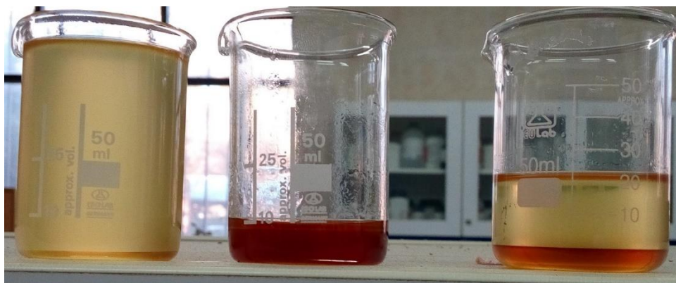
شکل ۳-۵ نمونه‌های به‌دست آمده از آزمایش پنجم (بشر وسط گلیسرین، بشر سمت چپ بیودیزل)
