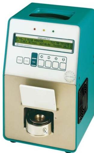
شکل ۳-۹ دستگاه اندازه‌گیری نقطه اشتعال (Mini Flash Point)
