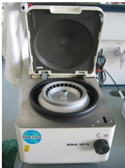
شکل ۳-۱۰ اندازه‌گیری مقدار آب بیودیزل با استفاده از سانتریفیوژ
