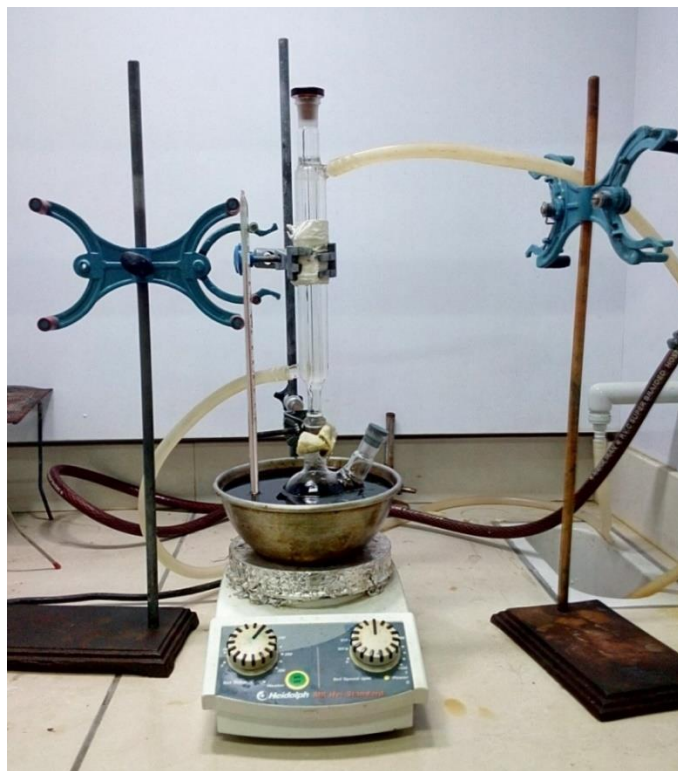
شکل ۳-۳ بالن حجمی دودهانه و شیشه رفلاکس متصل به بالای بالن حجمی (بالن درون حمام روغن قرار گرفت)
