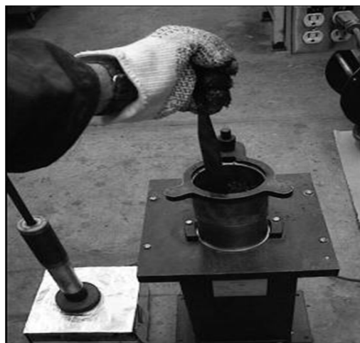
شکل ۳-۶ ریختن مصالح آغشته به قیر در قالب
