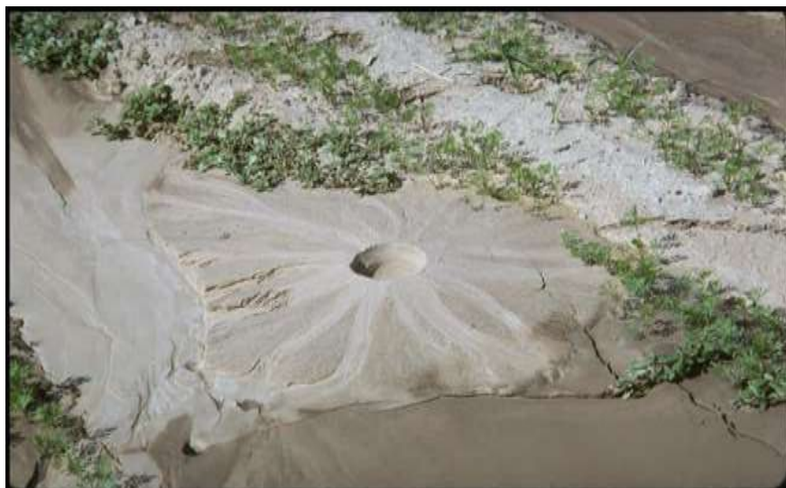
شکل ۲-۴ نمونه‌ای از جوشش ماسه در زلزله‌ی ۱۹۷۹ موسوم به دره‌ی امپریال، کالیفرنیا [۵۱]
