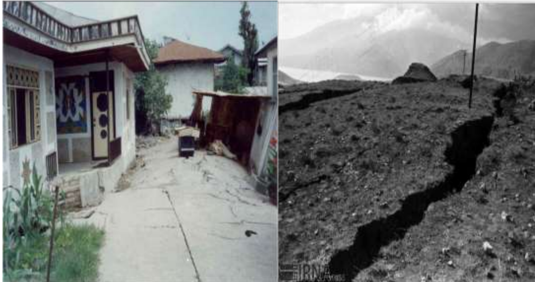
شکل ۲-۲ نشست ساختمان‌های مسکونی و دشت‌ها در زلزله‌ی رودبار-منجیل [۵۰]
