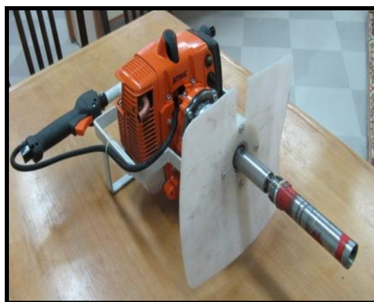
شکل ۲-۳۵- دستگاه مغزه‌برداری قابل حمل در صحرا.
