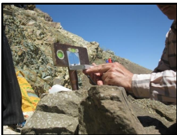
شکل ۲-۳۶- قبل از بیرون آوردن مغزه از زمین، شیب و جهت شیب مغزه توسط کمپاس و تراز یاب مغزه اندازه‌گیری می‌گردد.
