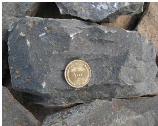
شکل ۳-۳۳- نمونه دستی بازالت منطقه کلاته‌سادات، بافت پورفیری و یکسری بلور که به شدت به اکسید آهن و احتمالاً الیوین ایدنگسیتی شده است، در آن مشخص می‌باشد.
