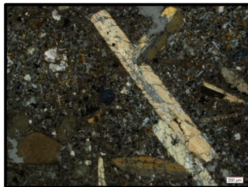
شکل ۲-۴۳- تصویری از حضور هورنبلند قهوه‌ای در دایک تراکی آندزیتی و زمینه سرشار از مگنتیت.
