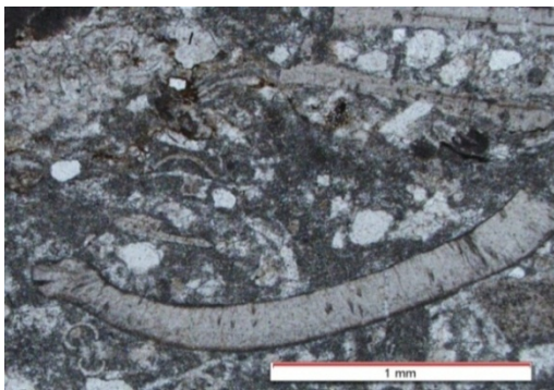
شکل ۲-۴۳- تصویر میکروسکوپی از فسیل تسولاریا (دوکفه‌ای) در سنگ آهک الیگوسن- میوسن (سندی بیوکلاست گرینستون) معادل سازند قم- PPL.
