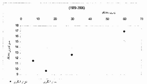
شکل ۵-۱۵- مقایسه متوسط عمق کانونی رخدادهای لرزه‌ای به فواصل مختلف از ساختمان سد در دوره قبل از آنگیری و بعد از آنگیری.
