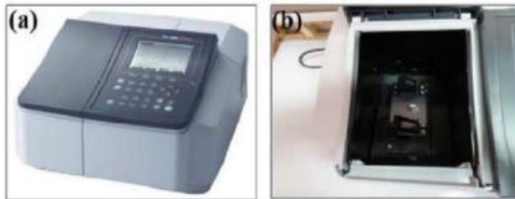
شکل ۲-۶: الف) طیف نگار مدل (UV-Vis, 1800) دانشگاه صنعتی شاهرود ب). جایگاه‌های قرارگیری نمونه‌های آزمایشی و شاهد برای تعیین ضرایب عبور و جذب.
