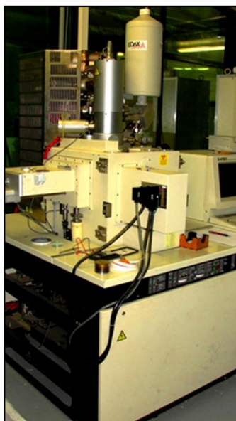
شکل (۲-۱۲): دستگاه SEM مدل Hitachi S-4160
