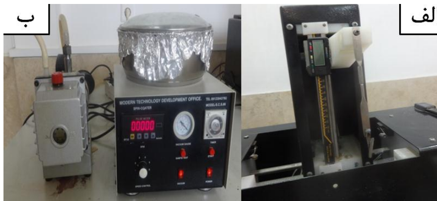
شکل ۲-۶: الف) دستگاه لایه نشانی غوطه وری و ب) دستگاه لایه نشانی چرخشی مورد استفاده در این پایان نامه.
