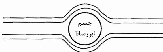
شکل (۳-۴) - خطوط میدان مغناطیسی در اطراف یک ابررسانای نوع اول
