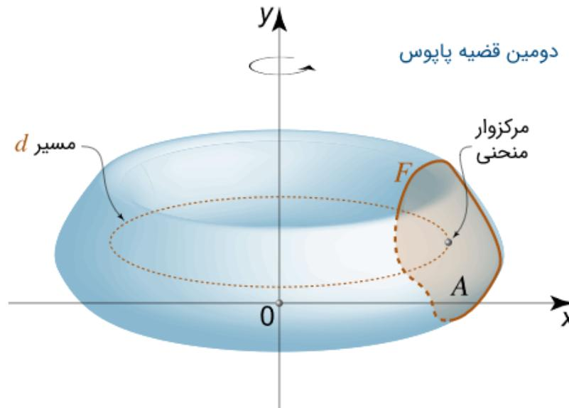
مثال: برای سطح هاشور خورده مطابق شکل مختصات مرکز سطح را مشخص کنید.
