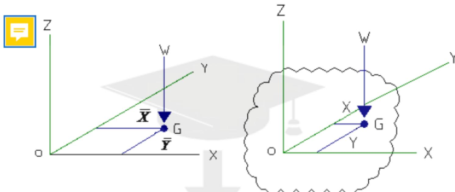
مختصات مرکز ثقل جسم دو بعدی نسبت به دستگاه
