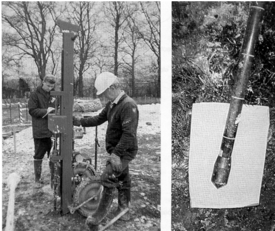
Fig. 5.19 Dynamic probing to DIN 4094.
